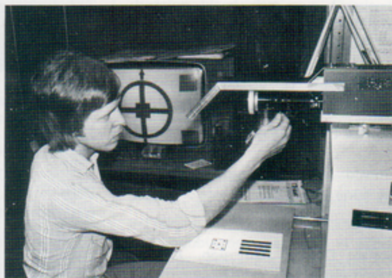
För den optiska finjusteringen av Magnivision använder Ingvar Gustavsson en speciell testbild
