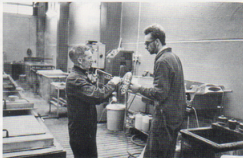
Leif Källsand med "eloxering", oxidering med hjälp av ström.
