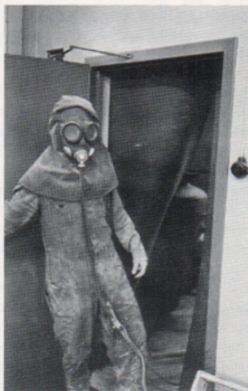
Ibland måste man ta till sandblästring för att få materielen ren. Då åker den här skyddsdressen på.
