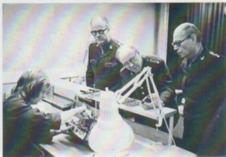
Rolf Karlsson modifierar Facit remsläsare. Det ställs stora krav på en utrustning som skall kunna läsa 1000 tecken per sekund.
