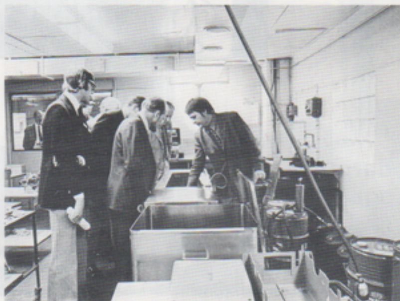
Rengöringen med freon är så materiellvänlig att man t o m kan doppa ner händerna i vätskan utan att ta skada, berättar Arne Hellstrand.
