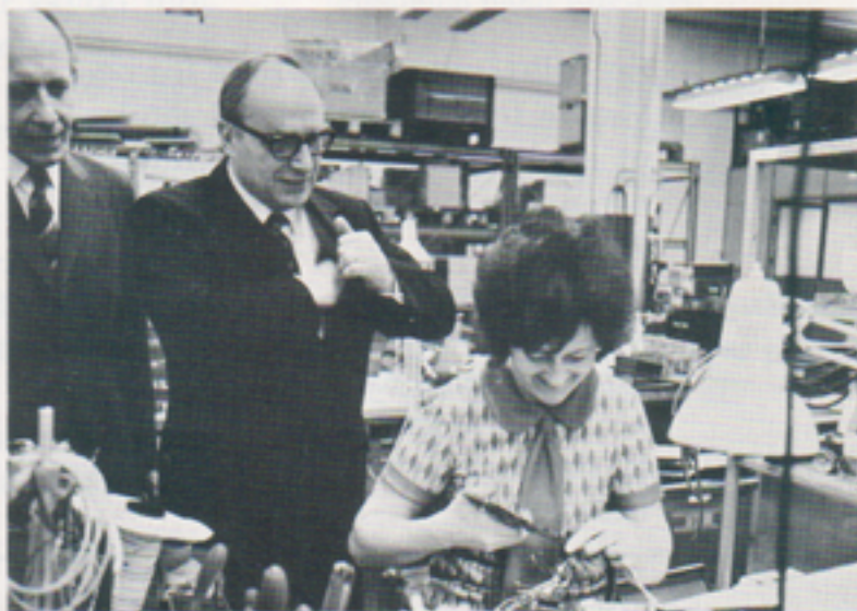
Karin Nilsson visar intresserad departementschef hur det går till att avisolera kabelstam till reagensenhet.
