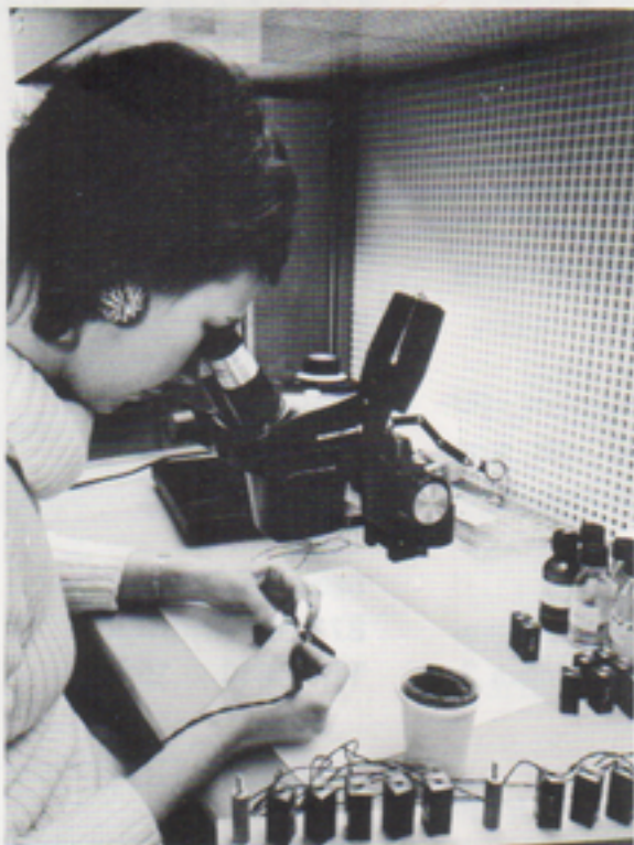
Fastklistring av givarkort och lödning av anslutningar fordrar stor noggrannhet. Yvonne Landin tar mikroskopet till hjälp.
