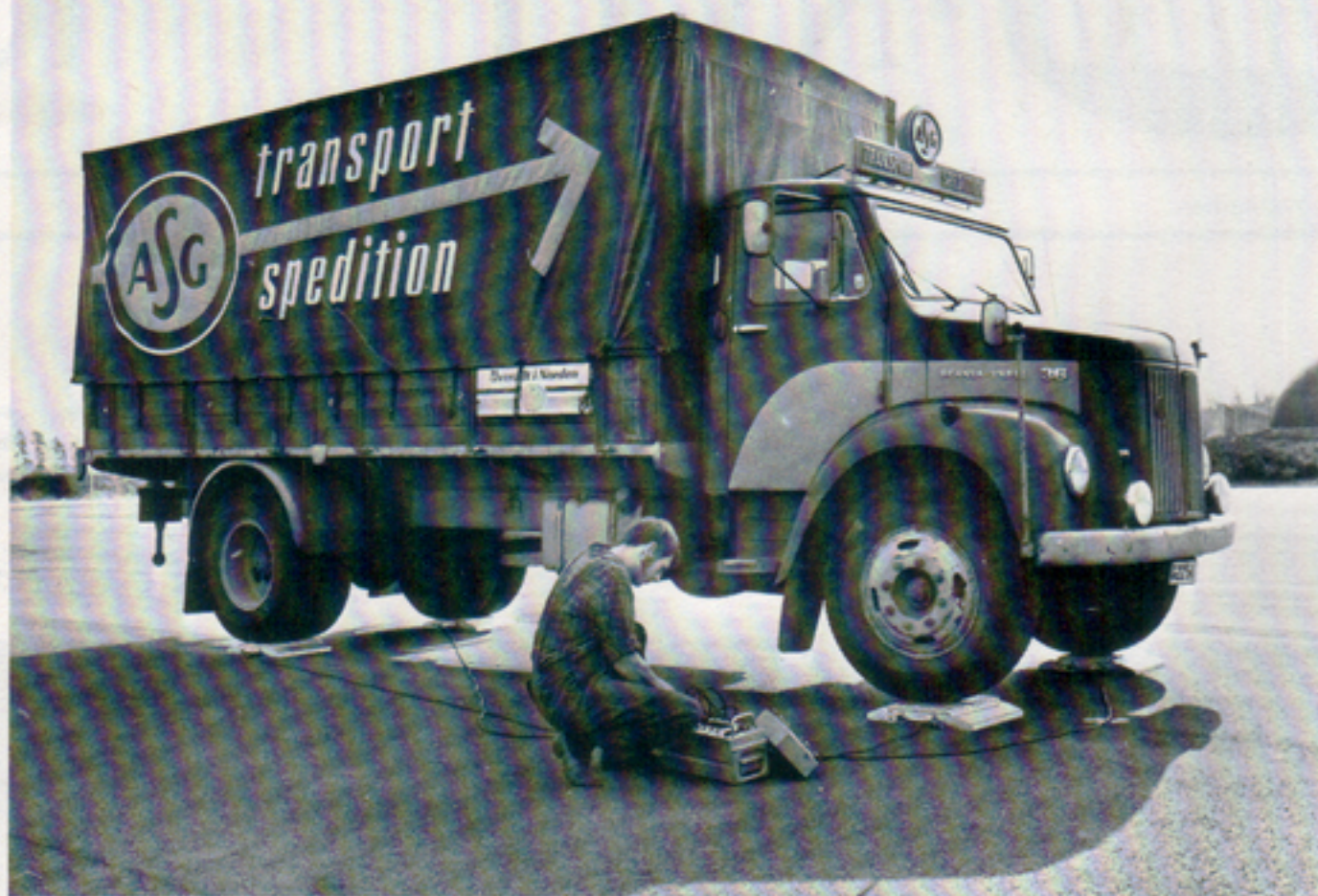
Fordonsvägen finns i flera versioner. Med den här typen (40 T) kan fordonsägaren kontrollera att inte övervikt föreligger och på så sätt undgå anmärkningar.
