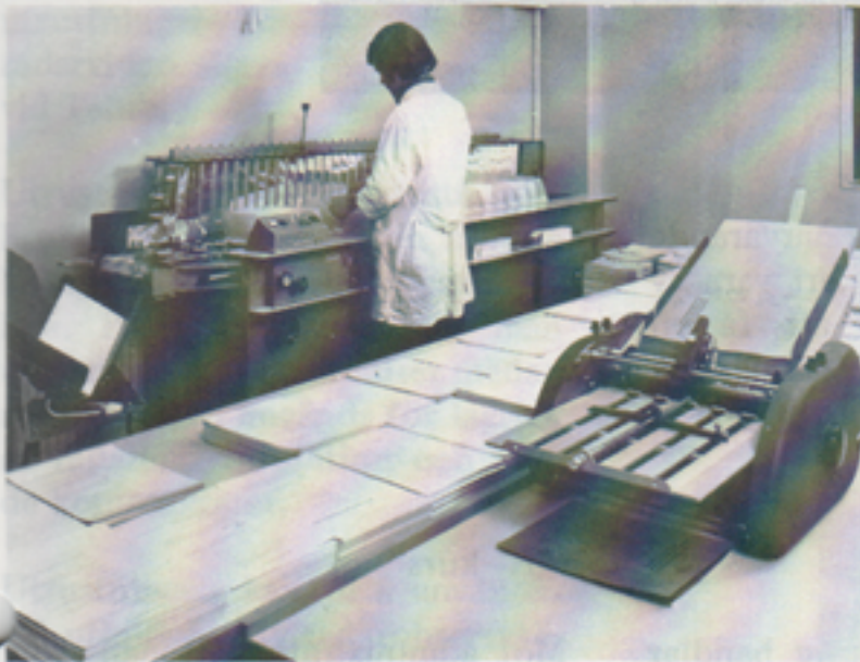
Bengt Adolfsson i arbete vid plockmaskinen i bokbinderiet. I förgrunden falsmaskinen, som viker arken till önskat format.
