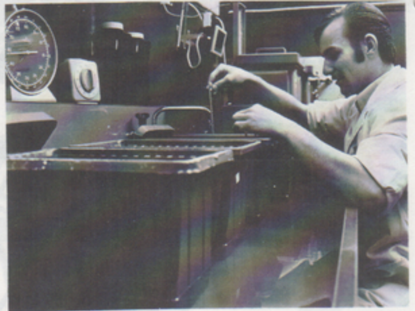
Jonny Henningsson framkallar filmerna (negativen) i »mörkrummet». Tankarna står i en tempereringsbassäng för att vätskorna skall hålla konstant temperatur.
