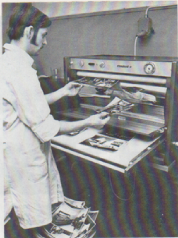
Tork- och höglanspressen. där fotokopiorna torkas.
