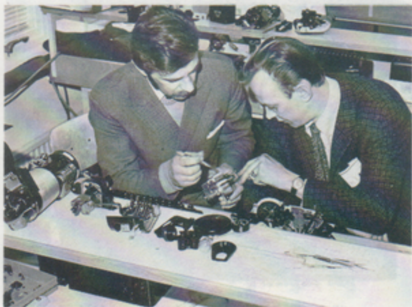
Fjärrskrivmaskin 308 demonterad i huvudenheter. Were- lius och Windahl diskuterar funktionen hos en detalj i skriftenheten.
