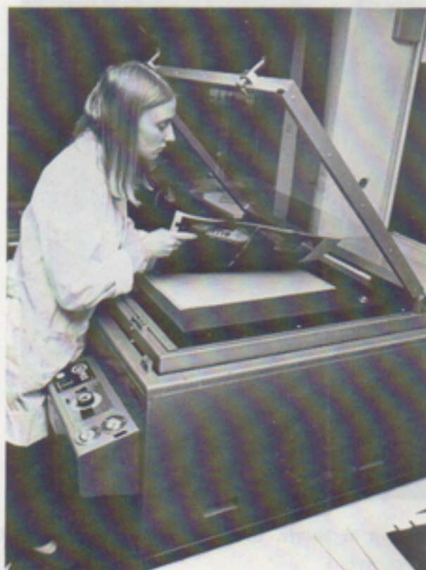
Negativen från tryckoriginalen monterats på montageark. Textnegativ och rasternegativ skärs ihop på samma ark.
