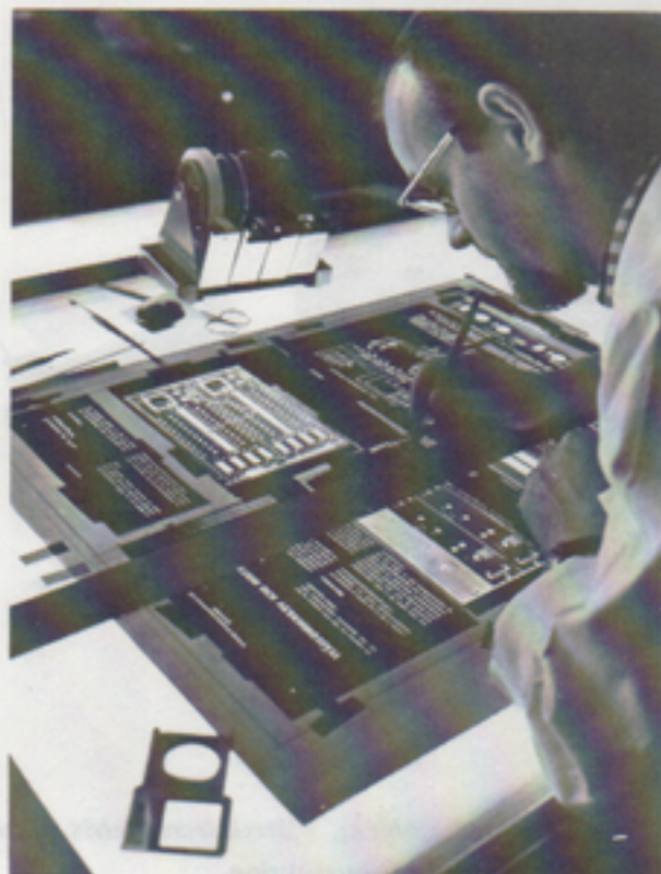
Negativen från tryckoriginalen monterats på montageark. Textnegativ och rasternegativ skärs ihop på samma ark.
