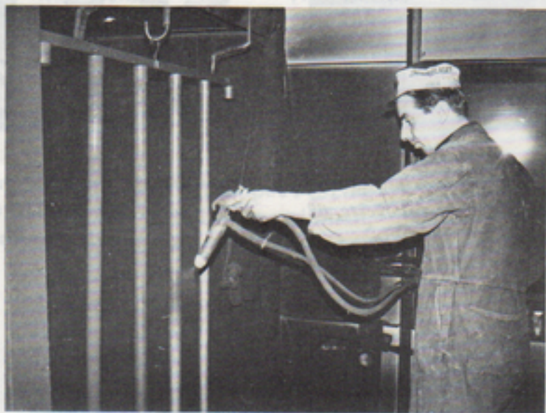
Sven Blomgren målar högantenner. Maströren sätts fast i ett stativ och se'n är det »bar» att spruta på. Det låga trycket spar färg – mycket litet går förlorat.
