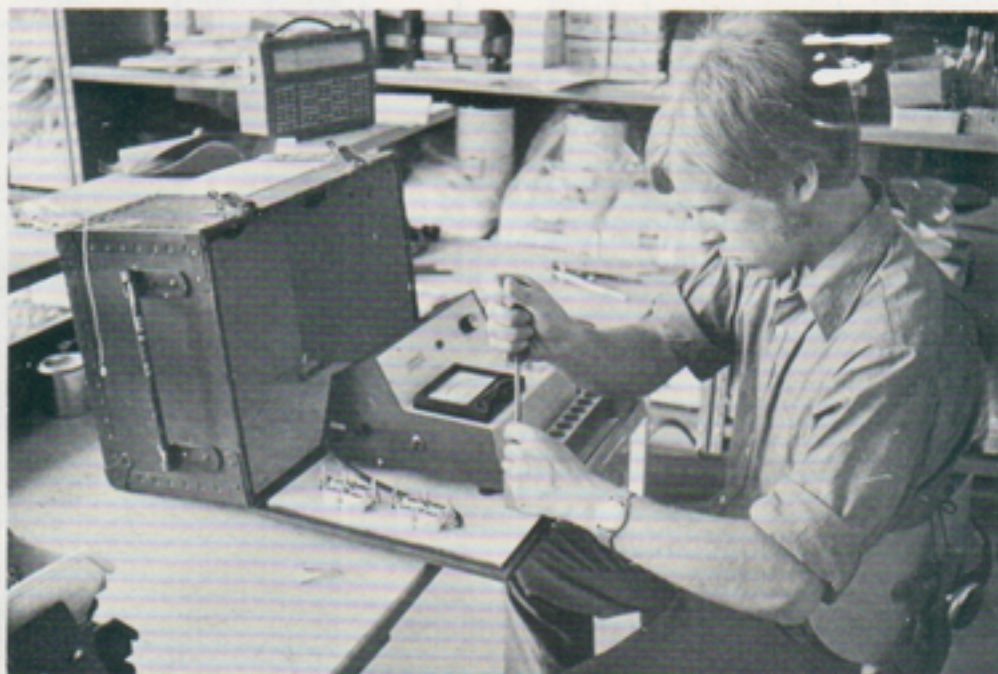
Fotometerlådan innehåller en fotometer, typ Linson 3, för blodanalys (ett av många exempel på hur den materiel som tillverkas vid VRE kan komma till användning). Monteringen görs här av Ingvar Gustavsson.
