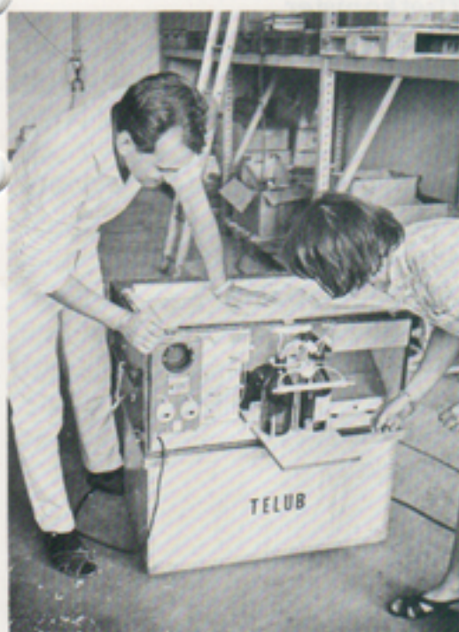
Celloskoplådan används för räkning av röda eller vita blodkroppar. Kennerth och Marica studerar monteringsdetaljer.
