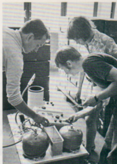
I flammfotometerlådan utnyttjar man en gasflamma olika färgning beroende på innehållet i de vätskor som förs in i lågan. Apparaten provas här av Kennerth Johansson och Åke Magnusson tillsammans med Marica af Ekström från AB Lars Ljungberg.
