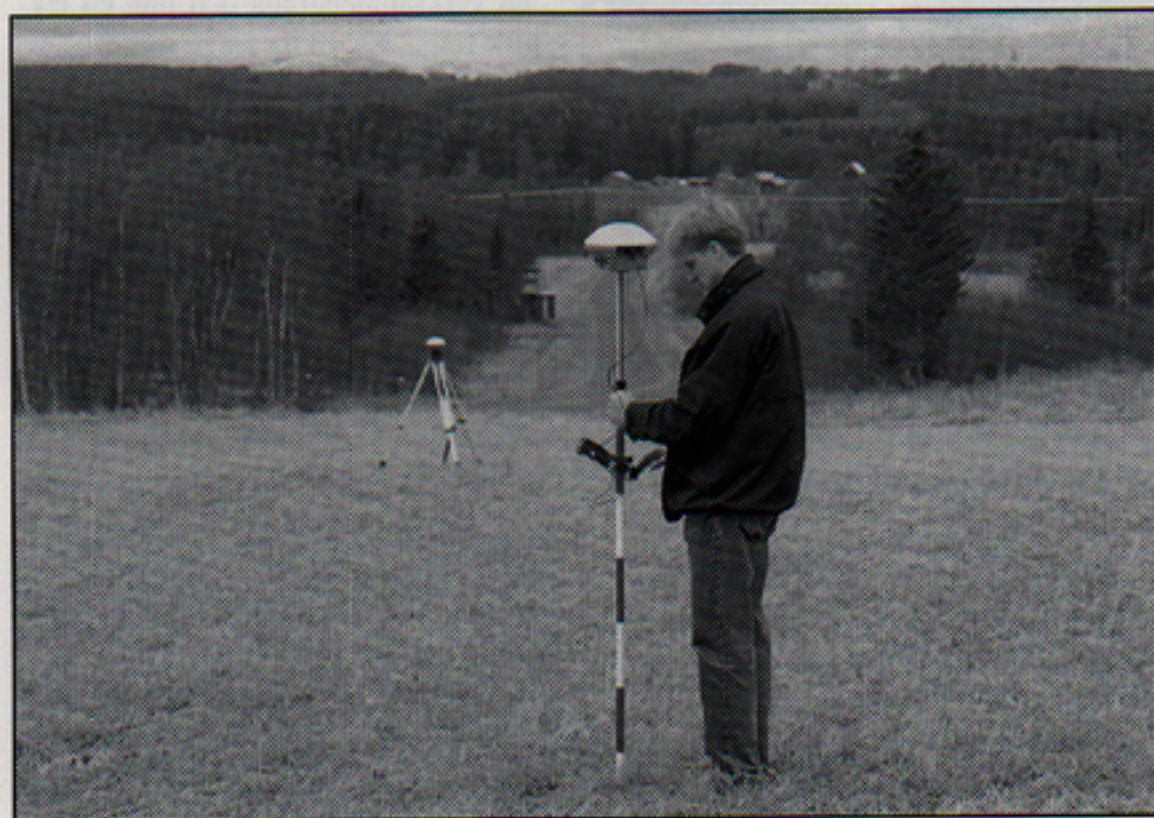
Tomas Persson utför med hjälp av GPS positionsbestämning av el- och flygplatsutrustning.
