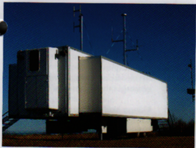
När vagnen är på plats vid något av försvarets skjutfält expanderas sidoväggarna och bredden fördubblas.
