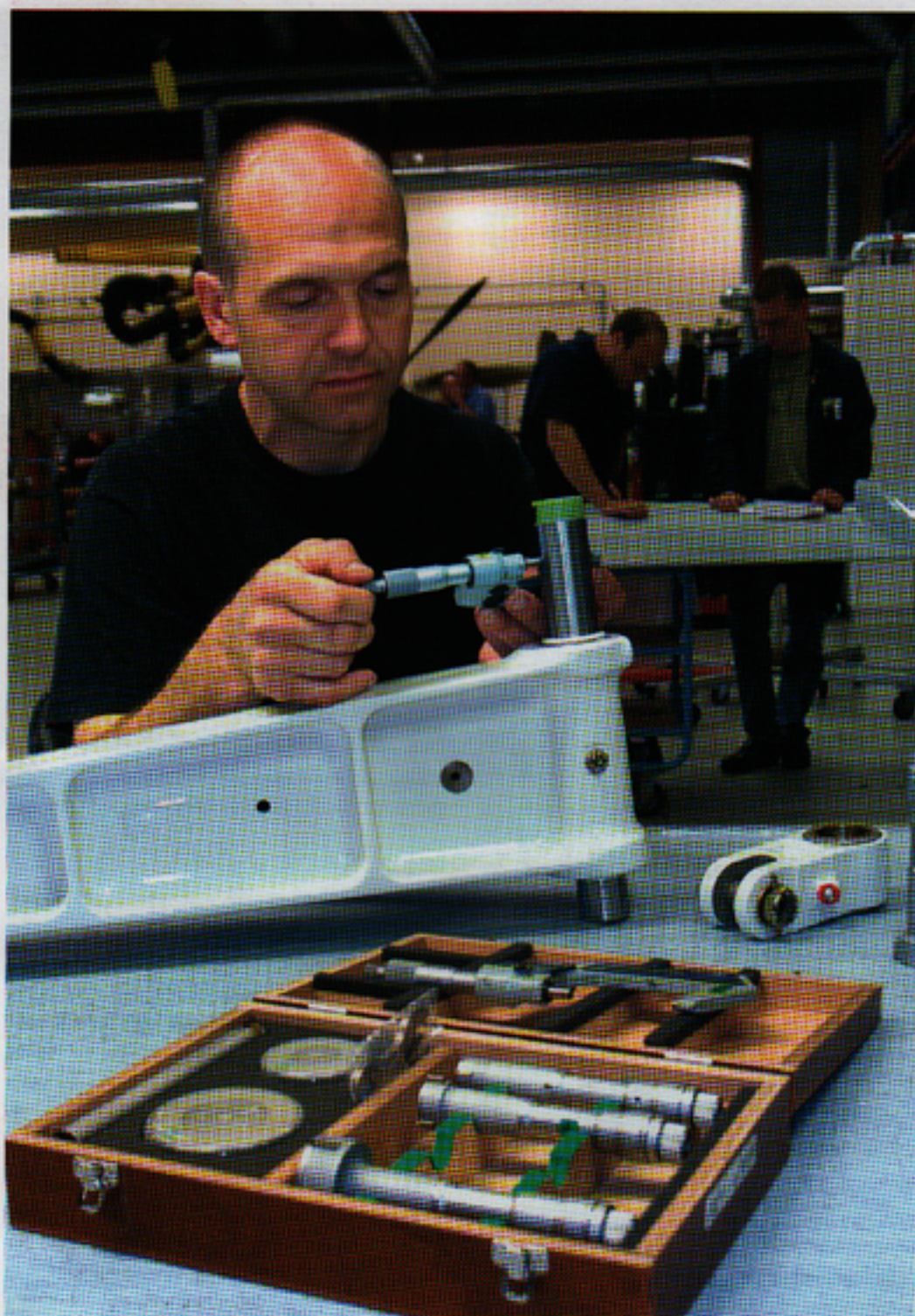
Claes Pettersson kontrollmäter axeln på den stötta som håller landningsstället i utfällt läge.
