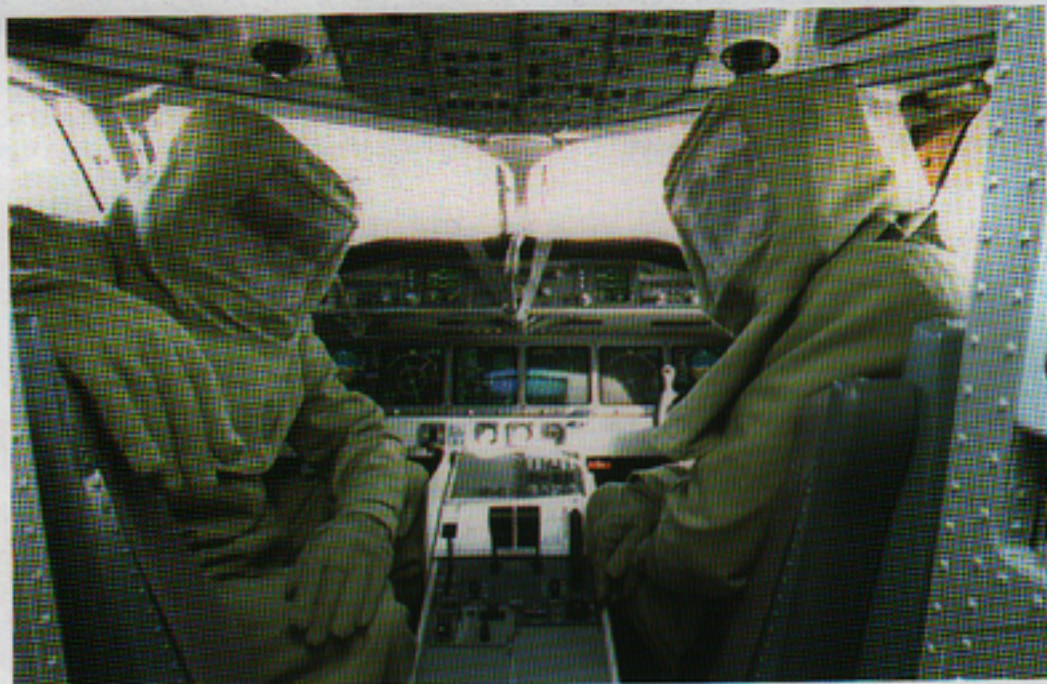
Flygplanens strålningstålighet testas även med piloter på plats. Säkerhetsåtgärderna är omfattande. Piloten och systemingenjören förbereder test av flygplanet Saab 2000.
