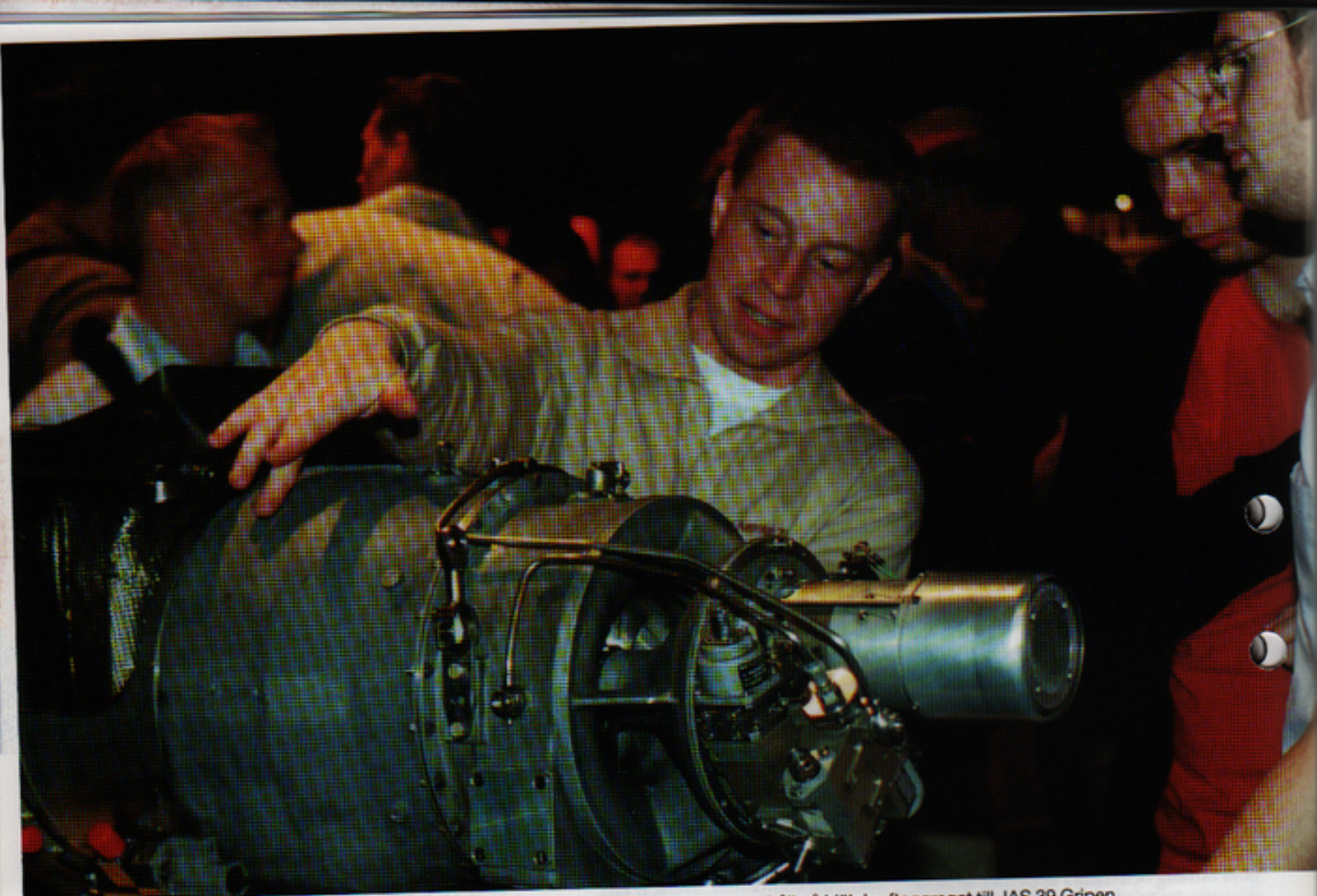
Mikael Karlsson från division MainPartner berättar om AerotechTelubs underhåll på hjälpkraftaggregat till JAS 39 Gripen.
