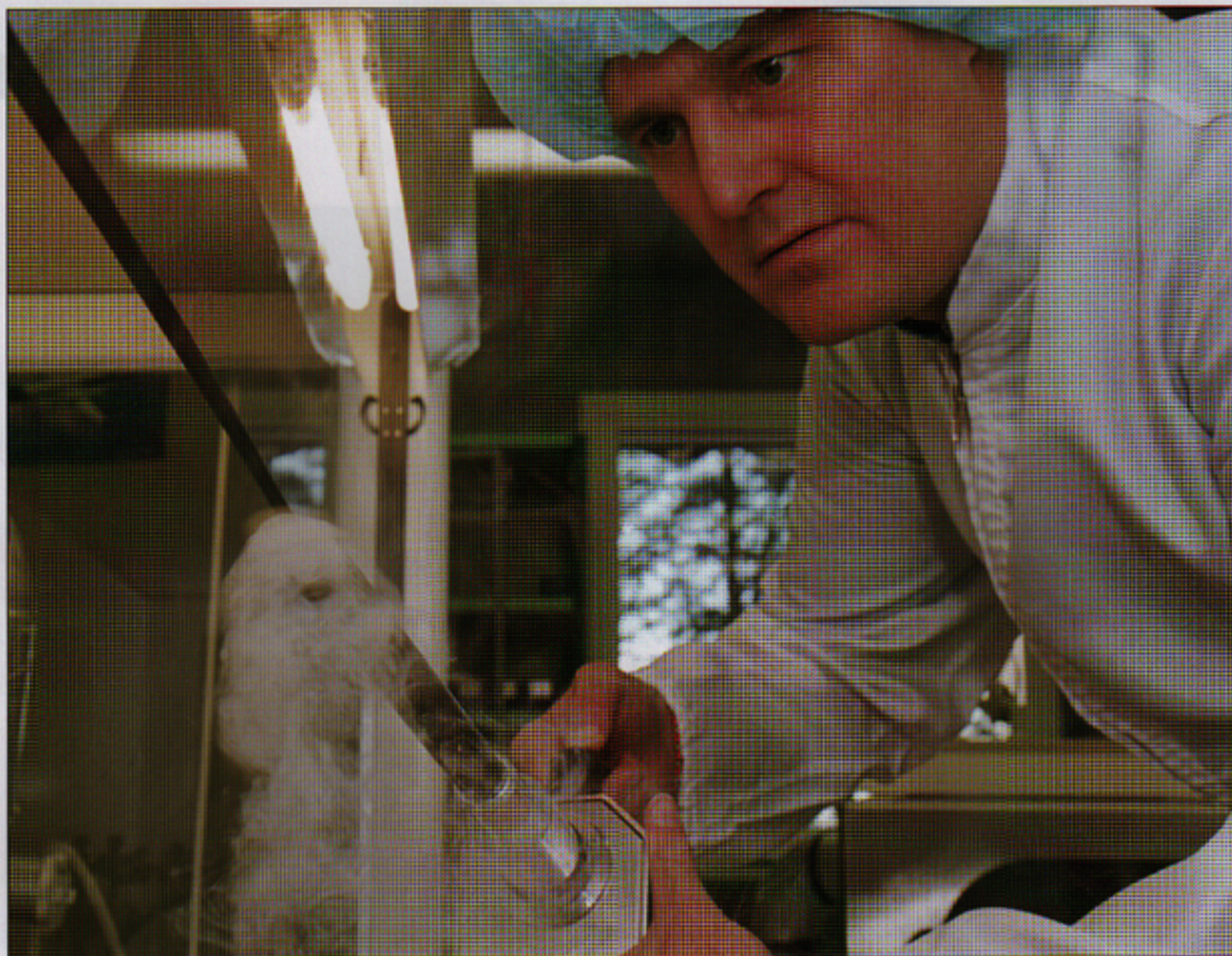
I LAF-bänken är det övertryck för att inte några partiklar från övriga renrummet ska komma in. Lars Jansson mäter luftströmmarna och kontrollerar att spärrverkan i bänken fungerar. Foto: Foto Malmen.
