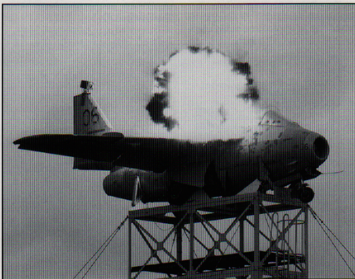
Markbaserade mål kräver inte så omfattande inmättningsinsatser som luftburna, men höghastighetskamerornas registrering av robotens uppförande från start till mål är betydelsefull för arbetet med utvärderingen.
