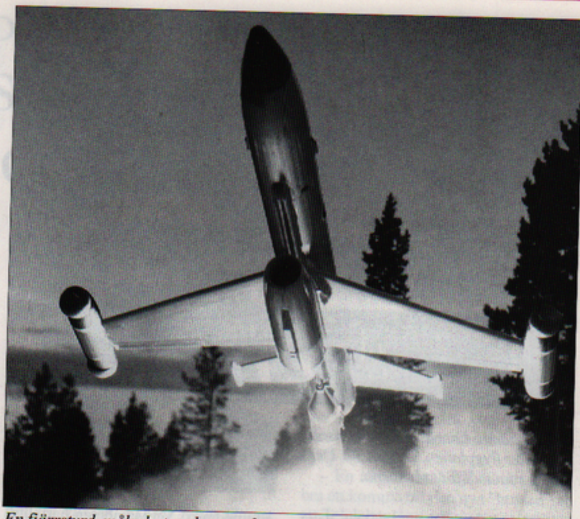
En fjärrstyrd målrobot under startfasen. Krutraketmotorn brinner under ett par sekunder och roboten accelererar till 400 km/tim.
