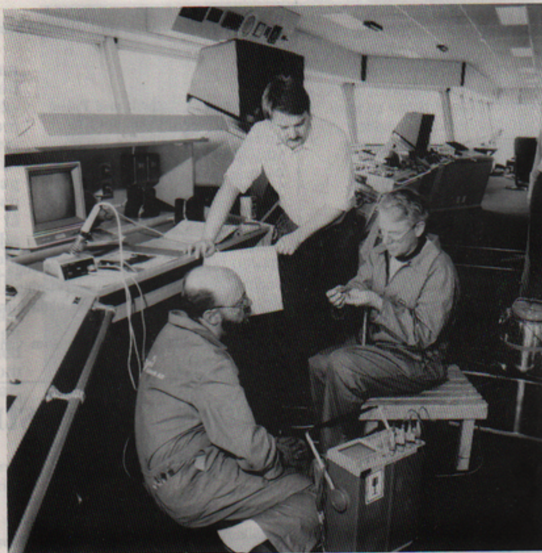
Roland Ahlberg (stående), Bengt-Olof Nygren och Erik Kraft, alla från Radaravdelningen i Växjö, modifierar "Atlantic Concerts" radarutrustning och installerar ett sjöklotterfilter.
