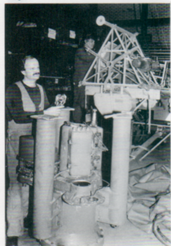
Håkan Ryman arbetade med att få detta vridbord, som skall sitta i en radarstation någonstans i Sverige, att fungera igen.
