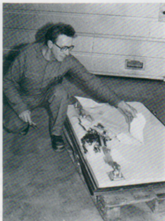
Östen Drugge, vår plastspecialist, skall få denna söndersprängda dörr av glasfiberarmerad plast hel igen.
