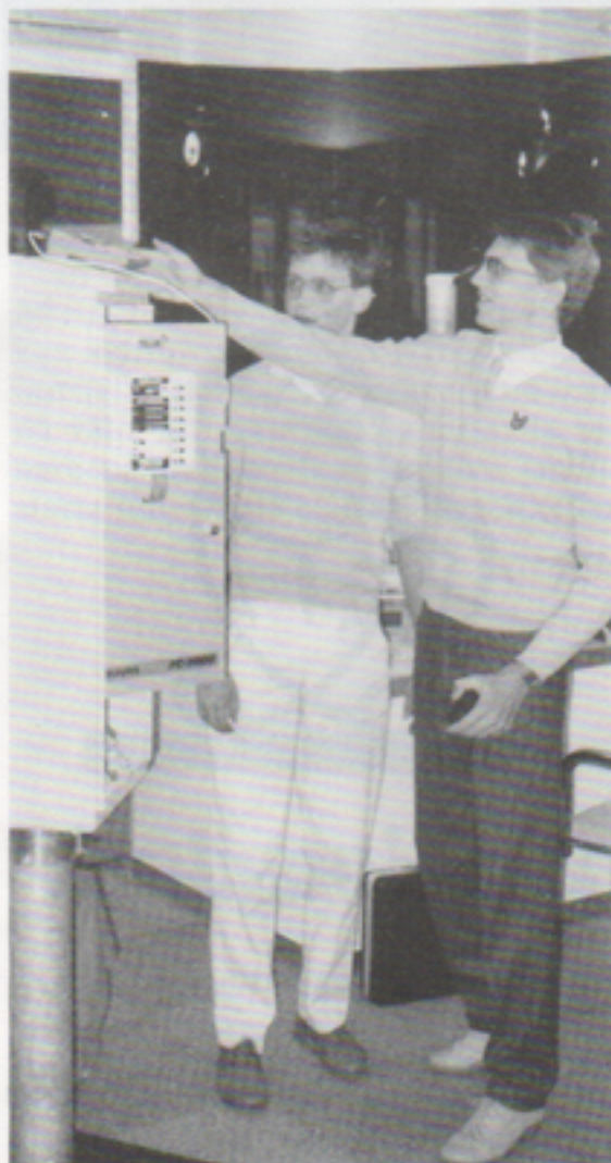
Jakko Pulkkinen och Håkan Stenfelt trimmar in en av våra styrapparater för styrning av trafiksignaler.
