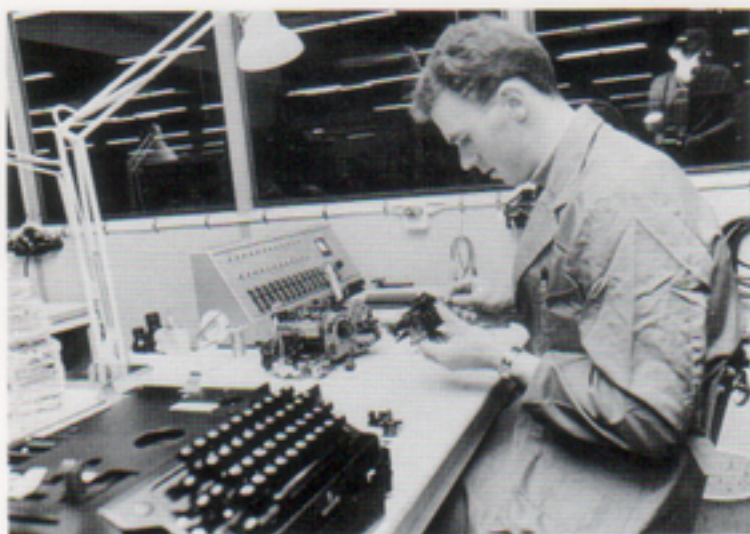
På fjärrskriftmaskinerna görs översyner, reparationer och kontroller med hjälp av flera olika utrustningar.
