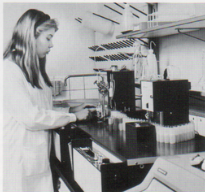
Huvuddelen i Linsons Autolab-system är en helautomatisk analysdel som med hjälp av interferensfilter och fotocell mäter färgavvikelse i blod.
